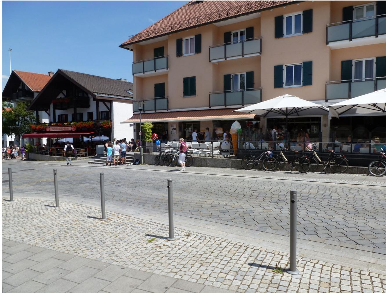
Leiser Straßenbelag, kein Kopfsteinpflaster, sondern Betonpflaster diagonal verlegt
